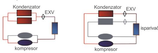
Sistem paralelnog rada
